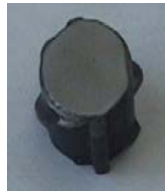
Рисунок 1 - Общий вид образца, поперечный темплет, сталь 35 ГС
