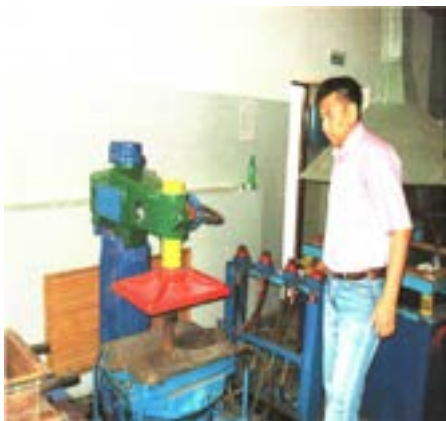
3 сурет – 6 тонналық зертханалық пресс
